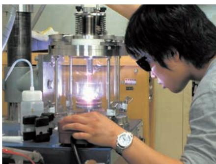
アーケ溶解炉による希土類金属化合物の作成
