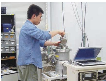
ナノ粒子作製のための真空蒸着装置
