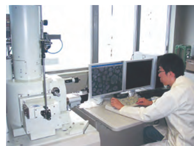
新規機能性材料の表面状態を電子顕微鏡によって観察
