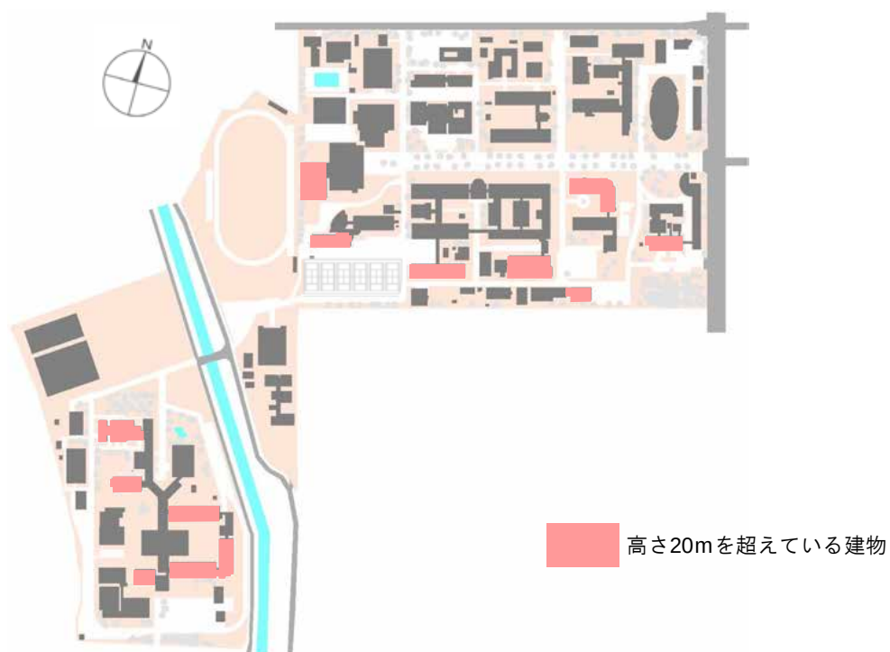
図表－5.60 高度規制により不適合となっている建物
