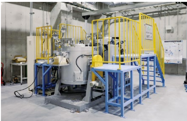
アルミニウム溶解精錬システム (アルミスクラップの溶解から鋳造まで一貫して行うことが可能)
