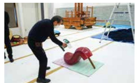
▲ 3Dスキャナーによる唐津くんち一番曳山「赤獅子」の計測
