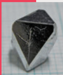
YFe 2 Zn 10 結晶と結晶構造
