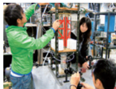
液体ヘリウム中に閉じ込めた原子のレーザー分光実験
