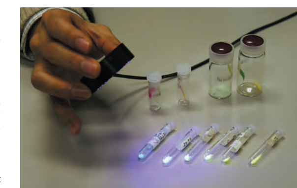
紫外線ランプを浴びて光る銀と銅の化合物。少しずつ銅を加えていくことで、色がグラデーションに変化している。左端は銀のみが入った色。右端の化合物には銅が1/400加わっている。
