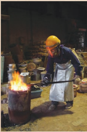
溶解炉から溶けた青銅の入った坩堝(るつぼ)を取り出す学生
